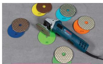
Disqueuse avec disque diamant
